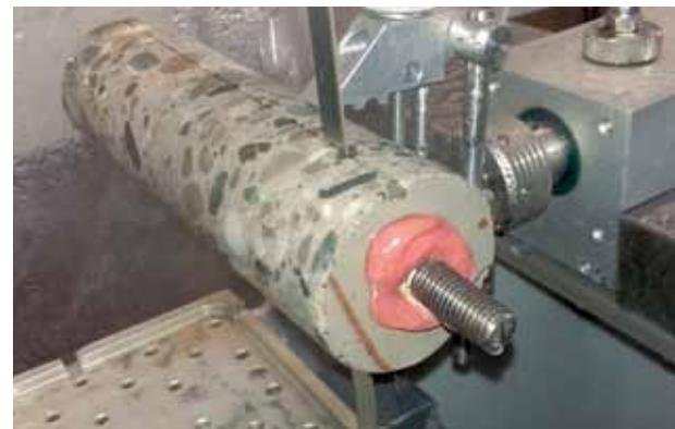
Industrie – Querschnitt eines Bohrkerns
