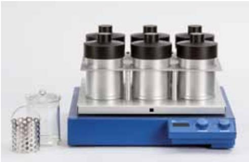
Entwässerungs- und Infiltrationsgerät EXAKT 510
