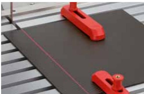
EXAKT 311 – Zuschnitt von CFK Streifen für Zugversuch
