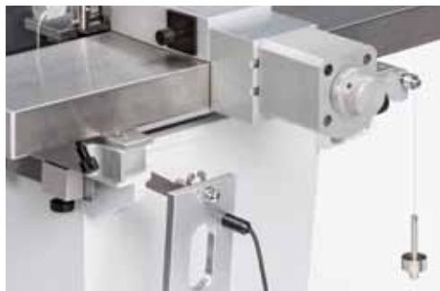
Parallelführung mit präziser Vorschubeinstellung und automatischer Probenzustellung
