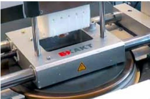
Vakuumkopf mit fixiertem Objektträger
