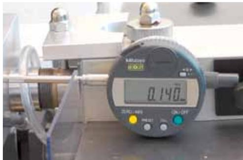
µ-genaue Probenzustellung mit Digital-Mikrometer
