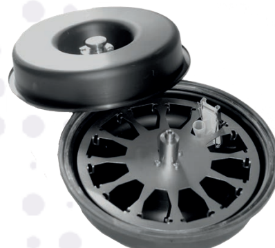
Geschlossener Rotor Shandon®-Clip-kompatibel
