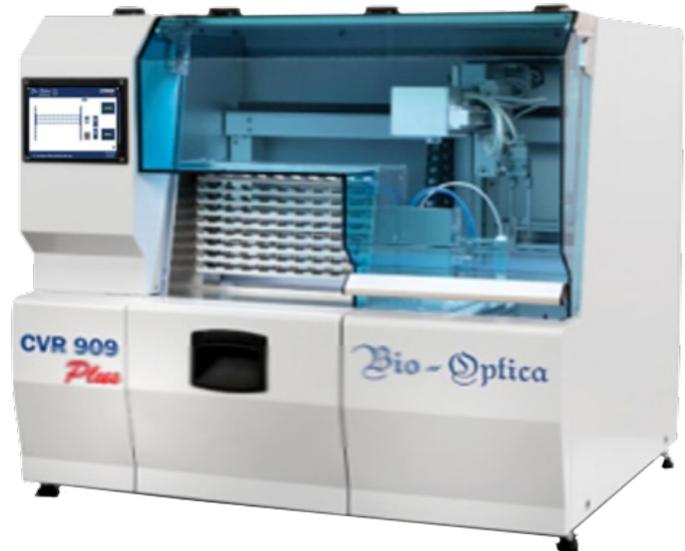
Möglichkeit der Verwendung von Deckgläsern mit drei unterschiedlichen Größen (24x40 , 24x50 , 24x60), sowie die Möglichkeit der Einstellung der Menge und der Art der Abgabe des Eindeckmediums.
