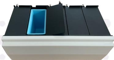
Die Reagenzstationen bestehen aus Standard-Bio-Optica-Küvetten (300 ml / ca. 250 ml Reagenz), und sind einzeln mit seitlich öffnenden Deckeln versehen. Während der Färbung öffnet der Färber automatisch die Station einzeln, die als Nächstes benutzt werden soll. Die anderen Stationen bleiben geschlossen. Nach der Benutzung der Station schließt das Gerät den Deckel wieder. So ist gewährleistet, dass möglichst wenig Verdunstung stattfindet.
