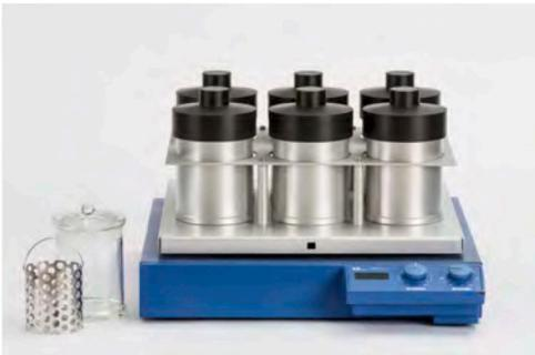
Entwässerungs- und Infiltrationsgerät EXAKT 510
