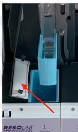
Seitlich unter dem Färbehälter ist ein Abtropf-System eingebaut. Nachdem der Färbehälter aus einer Färbestation herausgezogen ist, schwenkt dieses Abtropf-System unter den Färbehälter, um Rest-Tropfmengen aufzunehmen. So wird weniger Reagenz im Gerät verteilt oder in die nächste Station verschleppt.
