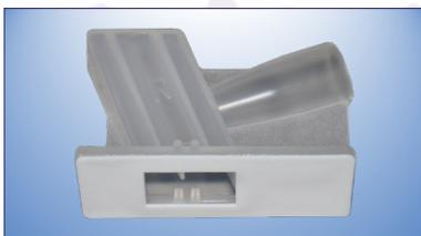
**Eine Kammer für 1 Probe. Rechteckiges Sedimentationsfeld, circa 14 x 21 mm , Probenvolumen bis circa 5 ml**
