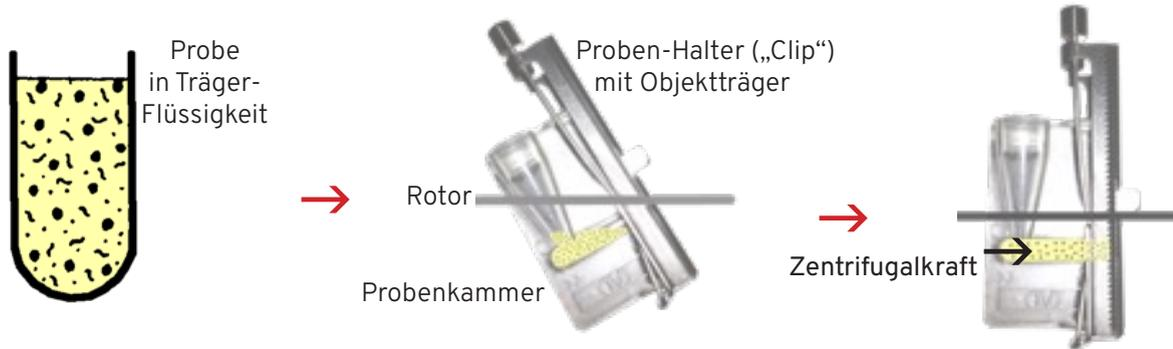
Die in der Träger-Flüssigkeit verteilte Probe wird durch Zentrifugalkraft auf den im Probenhalter eingespannten Objektträger aufgebracht. Die Träger-Flüssigkeit wird bei vielen Probenkammer-Ausführungen durch ein Filterpapier aufgenommen.
