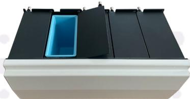
Die Reagenzstationen bestehen aus Standard-Bio-Optica-Küvetten (300 ml / ca. 250-280 ml Reagenz), und sind einzeln mit seitlich öffnenden Deckeln versehen. Während der Färbung öffnet der Färber automatisch die Station einzeln, die als Nächstes benutzt werden soll. Die anderen Stationen bleiben geschlossen. Nach der Benutzung der Station schließt das Gerät den Deckel wieder. So ist gewährleistet, dass möglichst wenig Verdunstung stattfindet.
